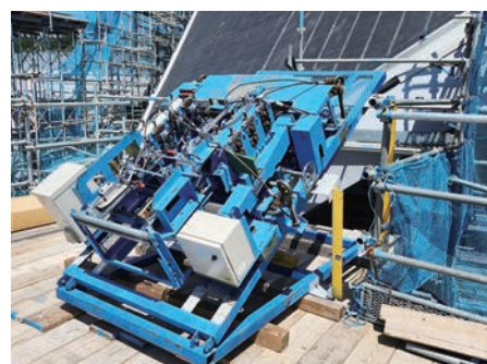
テーパー成型機。テーパー加工のための成型機。経験と感覚を頼りに微妙な誤差を調整する
