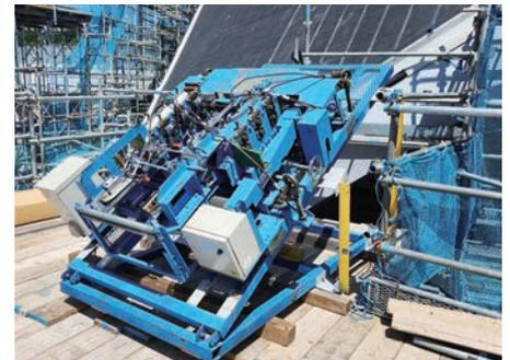
テーパー成型機。テーパー加工のための成型機。経験と感覚を頼りに微妙な誤差を調整する
