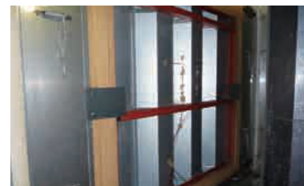
環境実験装置 熱貫流率試験
