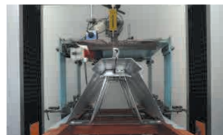
万能試験装置 SSR強度試験(折版固定金具)
