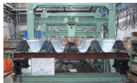
載荷試験装置 載荷試験
