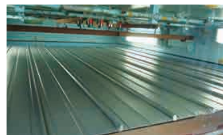
動風圧試験装置 耐風圧試験
