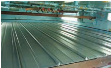
動風圧試験装置 耐風圧試験
